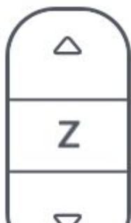
Джойстик вертикального перемещения (ось Z) каретки с экструдером.
