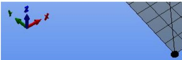
Точка в углу стола в программе соответствует нижнему левому углу стола 3д принтера.
