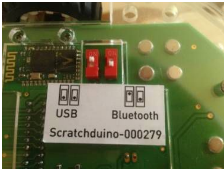
Рис. 142. Положение переключателей при bluetooth-соединении.
