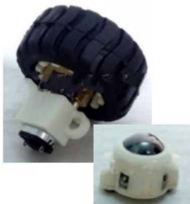
Рис. 156. Устройства движения: редукторный мотор с колёсами и шаровая опора.
