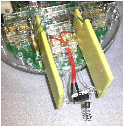
Рис. 56. Модификации датчика касания и шоры на датчики света.
