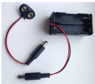
Рис. 13. Клипса под батарейку типа «Крона» и батарейный отсек для четырёх элементов АА.
