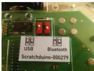
Рис. 15. Положение переключателей при bluetooth-соединении.
