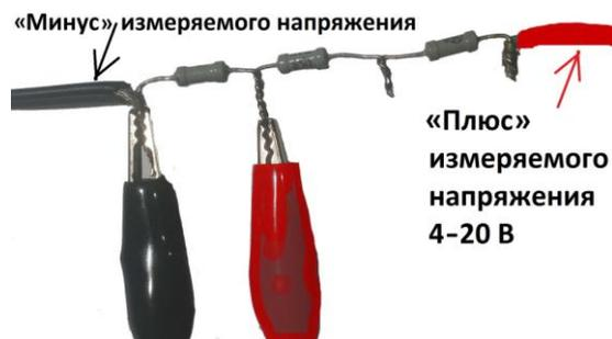
Рис. 43. Вид устройства «Делитель напряжения», собранного из трёх резисторов по 91 кОм и присоединённых «крокодилов».
