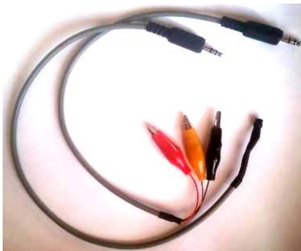
*Рис. 11. Выносной датчик температуры и соединительный шнур с тремя зажимами-«крокодилами».*
