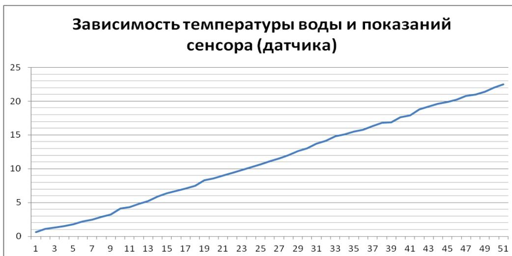
*Рис. 16. График зависимости показаний выносного датчика от температуры, измеряемой бытовым термометром.*
